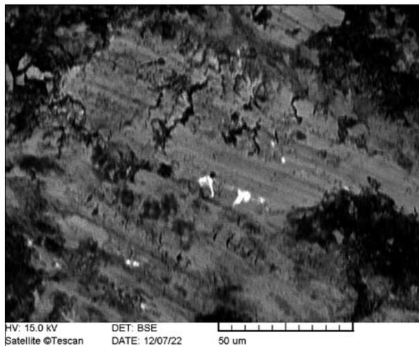
Fig. 5. Frammenti metallici ricchi di piombo, angolari e con angoli a uncino, incorporati nella lega omogenea. Fotografia al microscopio elettronico. Foto: M. Bíró (Department of Mineralogy, Eötvös L. University, Budapest).
