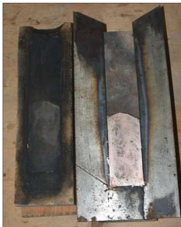
Fig. 2. Staffa di ferro e blocchi di arenaria refrattaria.
