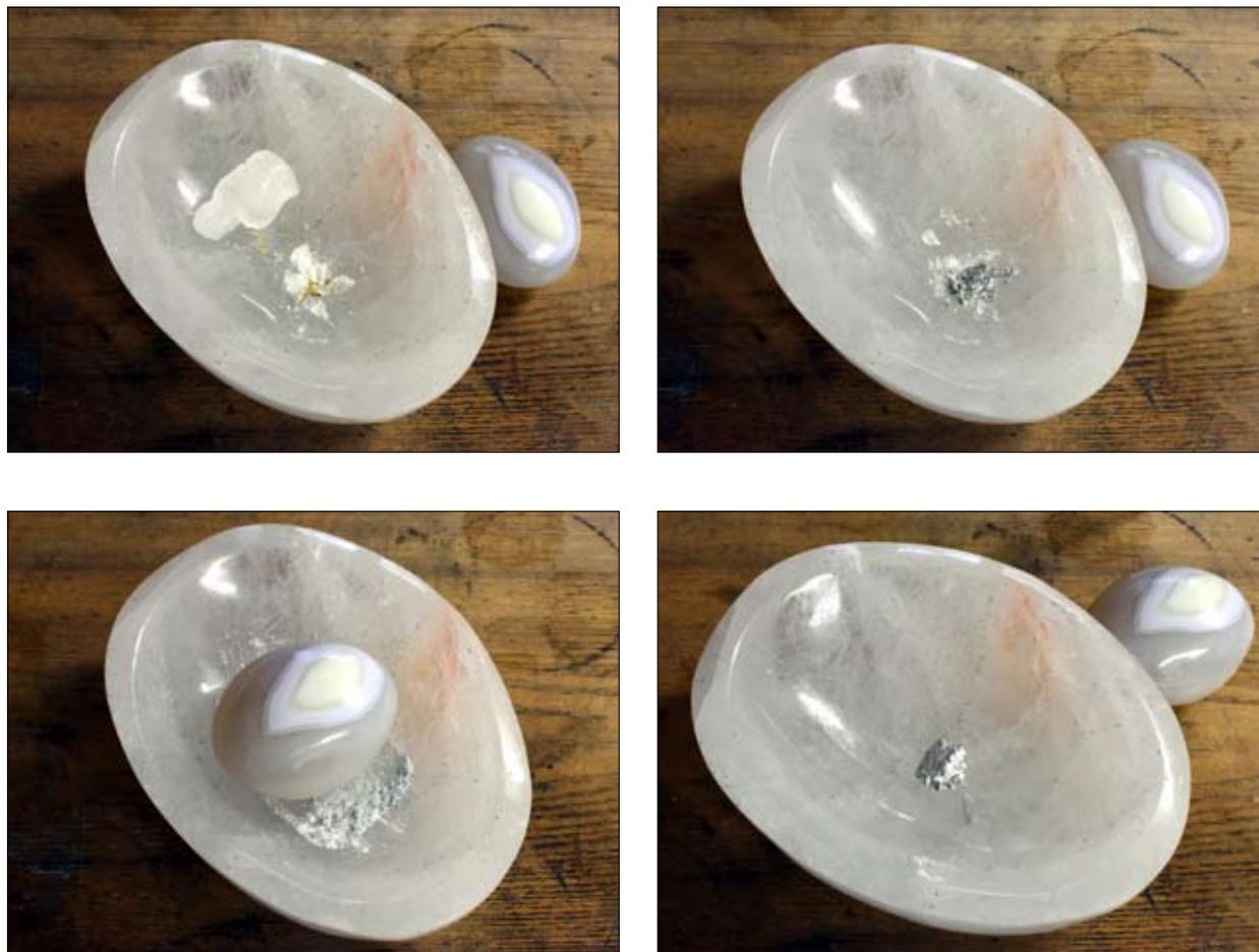
Figg. 3-6. Fasi di preparazione dell'amalgama con mortaio e pestello di agata.
