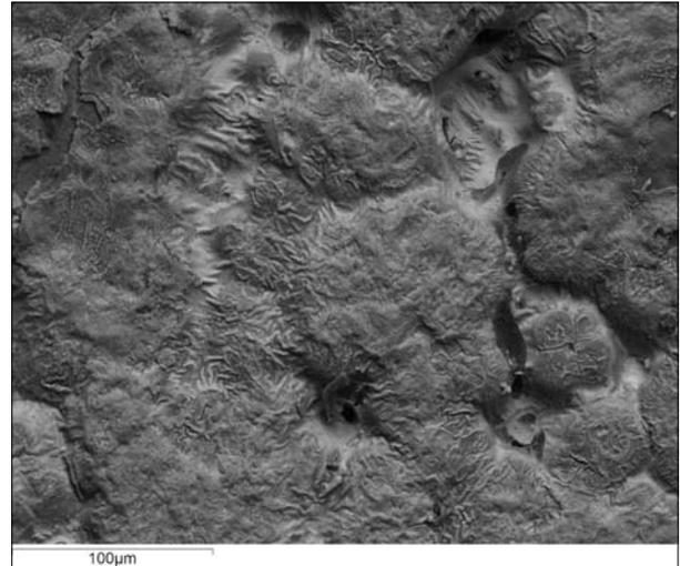
Fig. 15. Immagine al microscopio elettronico a scansione in elettroni retrodiffusi della superficie di un provino in bronzo contenente il 15% di piombo nella quale si evidenzia una superficie molto irregolare e rugosa costituita da una fase molto ricca in piombo ed oro (OPD).
