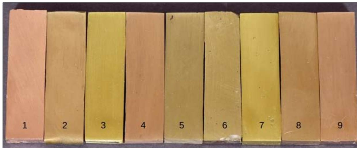
Fig. 1. Serie dei provini in diverse leghe di rame. Mancano il provino n. 10 e il n. 11 realizzati in una successiva fase della sperimentazione. Il n. 1 è quello usato per la prova di applicazione della foglia d'oro sull'amalgama.
